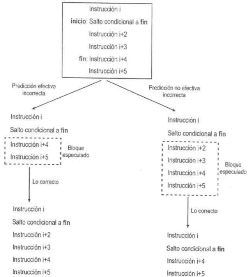
Figura 2.21: Un error de predicción conlleva la ejecución incorrecta de instrucciones que es necesario deshacer una vez conocido el resultado del salto.
