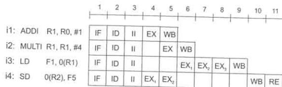
Figura 2.6: Terminación ordenada de instrucciones mediante la introducción de ciclos de detención.
