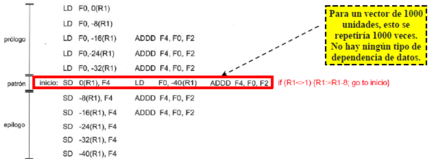
Figura 3.11: Instrucciones VLIW genéricas obtenidas a partir de la secuencia del bucle segmentado.
