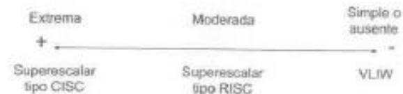
Figura 3.1: Evolución de la complejidad de los buffers de instrucciones, distribución, terminación y estaciones de reserva según el tipo de arquitectura.
