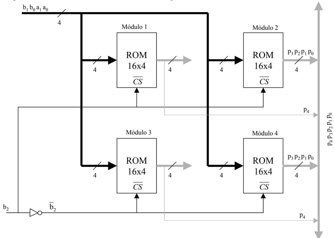
Comentar que con el bit  $b_2$  se selecciona el par de módulos donde se encuentra almacenado el resultado. Y con los bits  $b_1b_0a_1a_0$  ya se determina la posición de ROM que se va a leer.
