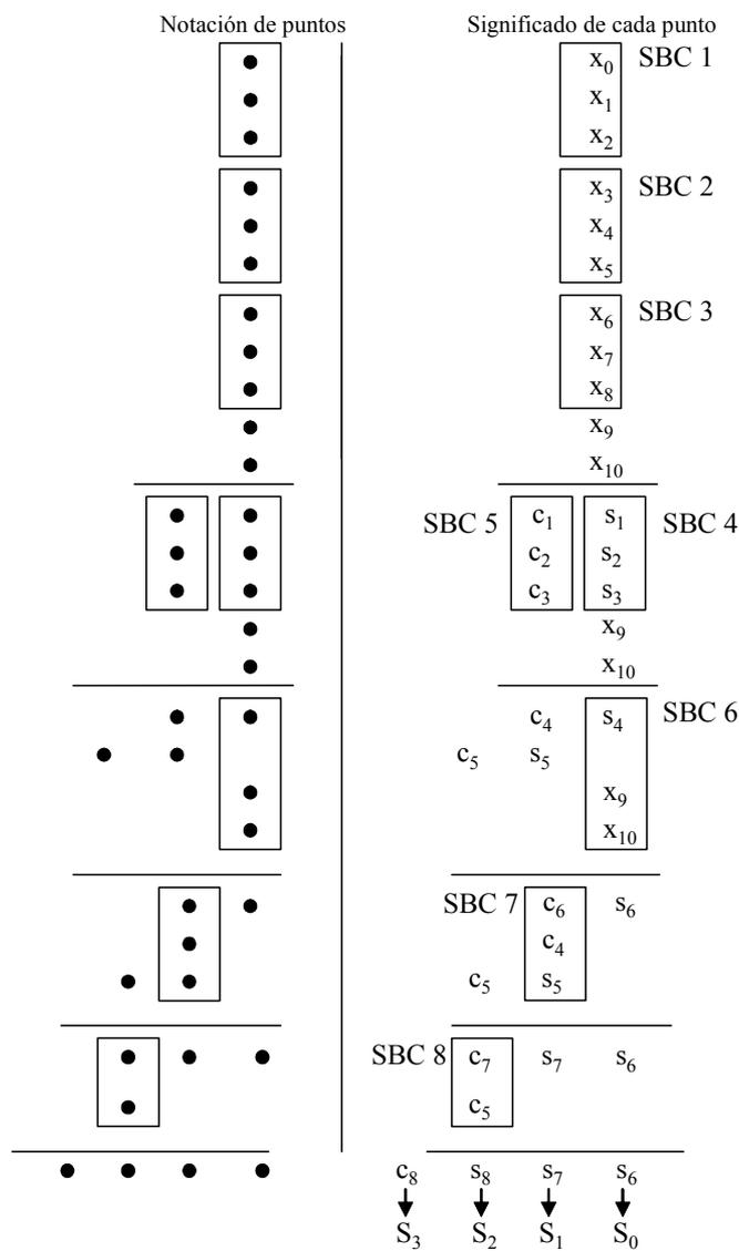
Luego se requieren como mínimo **8 SBCs** para diseñar un circuito combinacional que sea un sumador de 11 números de 1 bit de longitud.
