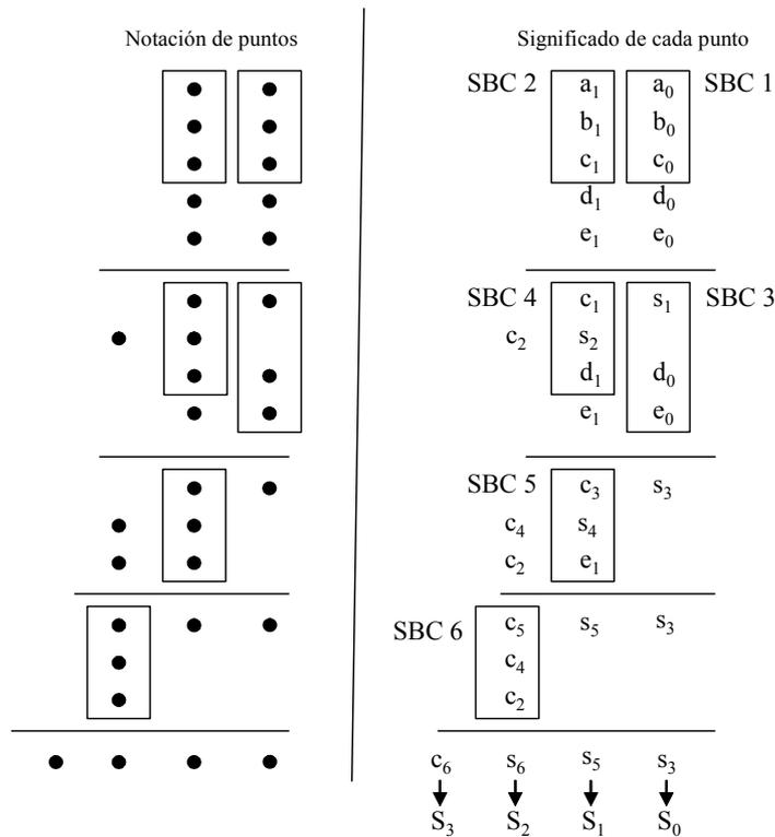
Luego se requieren como mínimo **6 SBCs** para diseñar un circuito combinacional que sea un sumador de 5 números de 2 bits de longitud.
