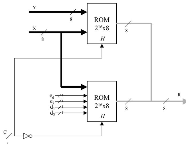
Con el inversor se utiliza para habilitar uno de los dos módulos de memoria ROM, de acuerdo con el valor de la señal  $C=1$  (Comparador) y  $C=0$  (Desplazador). Se tiene por tanto el esquema que se muestra en la Figura
