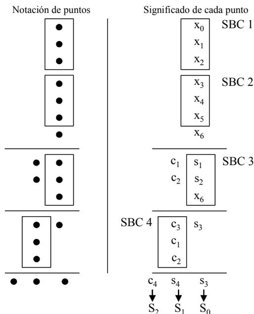
Luego se requieren como mínimo **4 SBCs** para diseñar un circuito combinacional que sea un sumador de 7 números de 1 bit de longitud.
