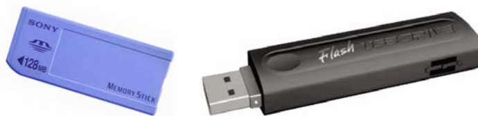
Figura 16. Dos ejemplos de tipos de memoria flash
