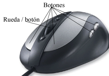
Figure 26. Ejemplo de ratón con ocho botones
