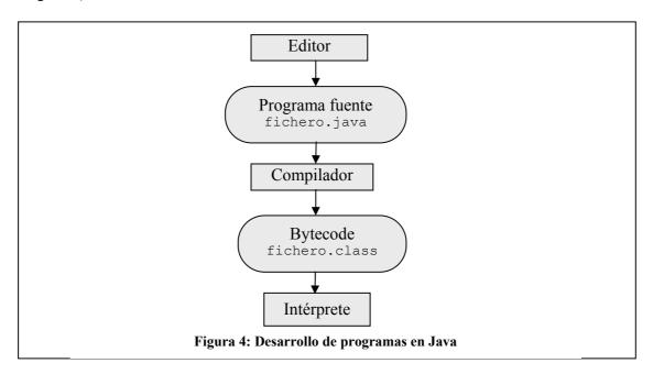
Primero se compila el programa fuente a un lenguaje intermedio (fichero.java en la figura), llamado *bytecode* (códigos de byte) (fichero.class en la figura), que es parecido al lenguaje máquina, pero independiente de una máquina concreta.
