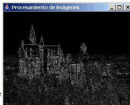
**Figura 5.6.** Aplicación de un *kernel* de tipo filtro pasa-alta
