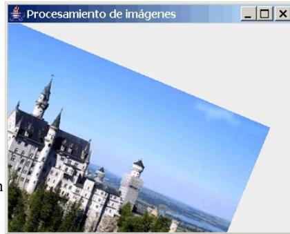
**Figura 5.8.** Renderizado de una imagen previamente rotada  $\pi/8$  radianes en el sentido de las agujas del reloj
