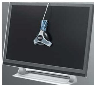
**Figura 6.3.** Dispositivo que se coloca en la pantalla del monitor y realiza una calibración automática del color, creando un perfil particularmente adaptado para visualizar de forma adecuada la gama estándar de colores.
