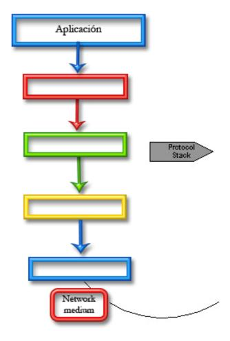
Como se muestra en la imagen anterior, los datos en el sistema transmisor se originan en una aplicación en la parte superior de la pila de protocolos y fluyen hacia abajo a trabes de las capas. Cada protocolo proporciona un servicio a un protocolo operando en la capa inferior. Al final de la pila de protocolos está el medio de red, que lleva los datos hacia otro equipo en la red.
